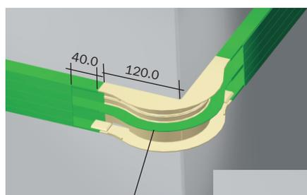
Espaços necessários para montagem da conexão.
